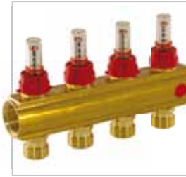
Collettore FF con uscite 3/4" M Eurocono e misuratori di portata
