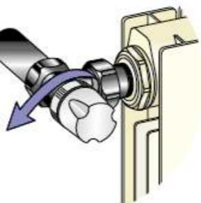
**Portare la testa termostatica nella posizione di massima temperatura della scala graduata.**
