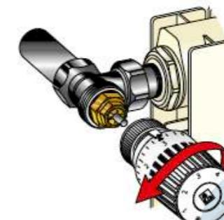
**Avvicinare la testa termostatica al corpo valvola e avvitare a fondo la ghiera di serraggio.**
