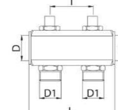
**332M÷340M****Collettore FF con uscite 3/4" M Eurocono e misuratori di portata.**
